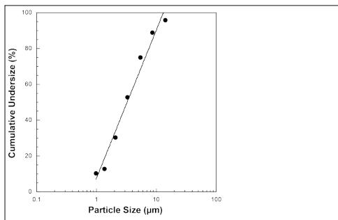
Die Messungen wurden mit einer Natrium-Fluorid-Lösung mit einem "Next Generation Impactor" (NGI) durchgeführt.
